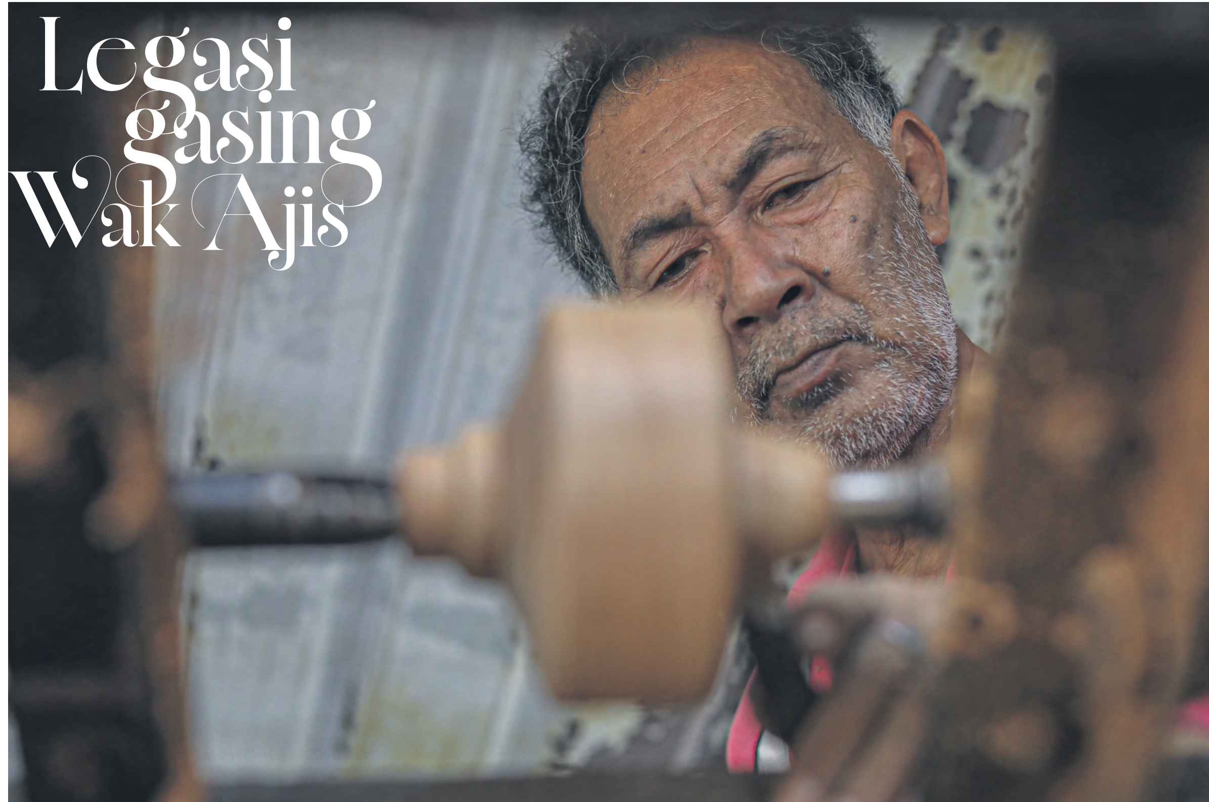
Wak Ajis membulatkan kayu dengan mesin sebelum mengukirnya bagi mengekalkan sentuhan tradisional
