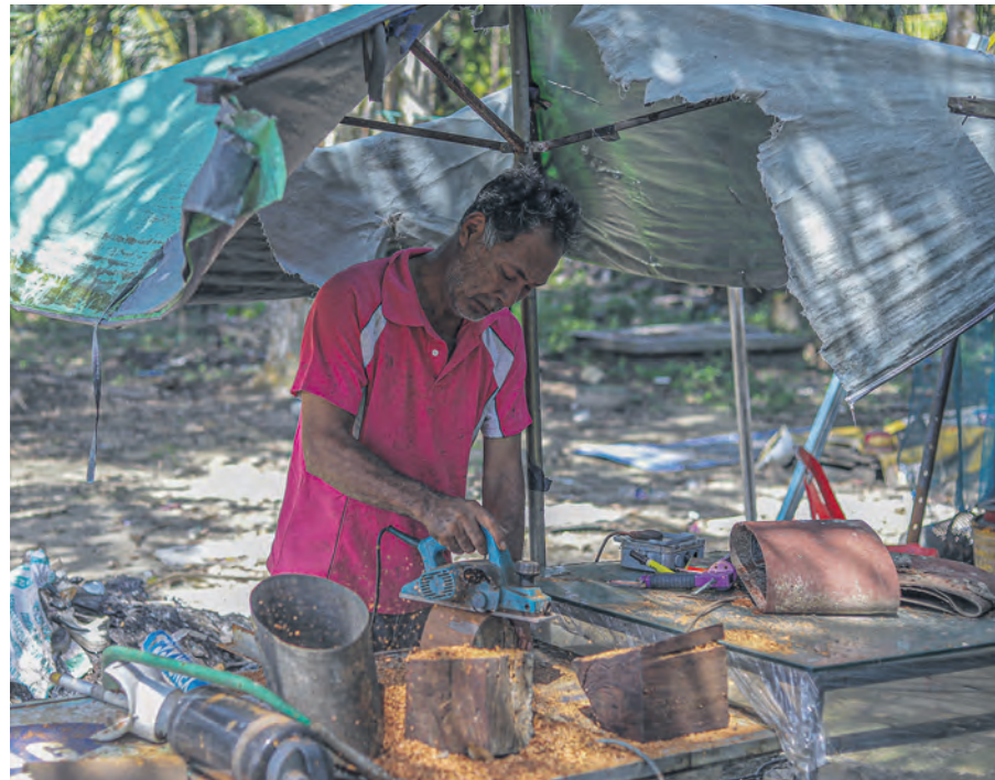
Wak Ajis membulatkan kayu dengan mesin sebelum mengukirnya bagi mengekalkan sentuhan tradisional
